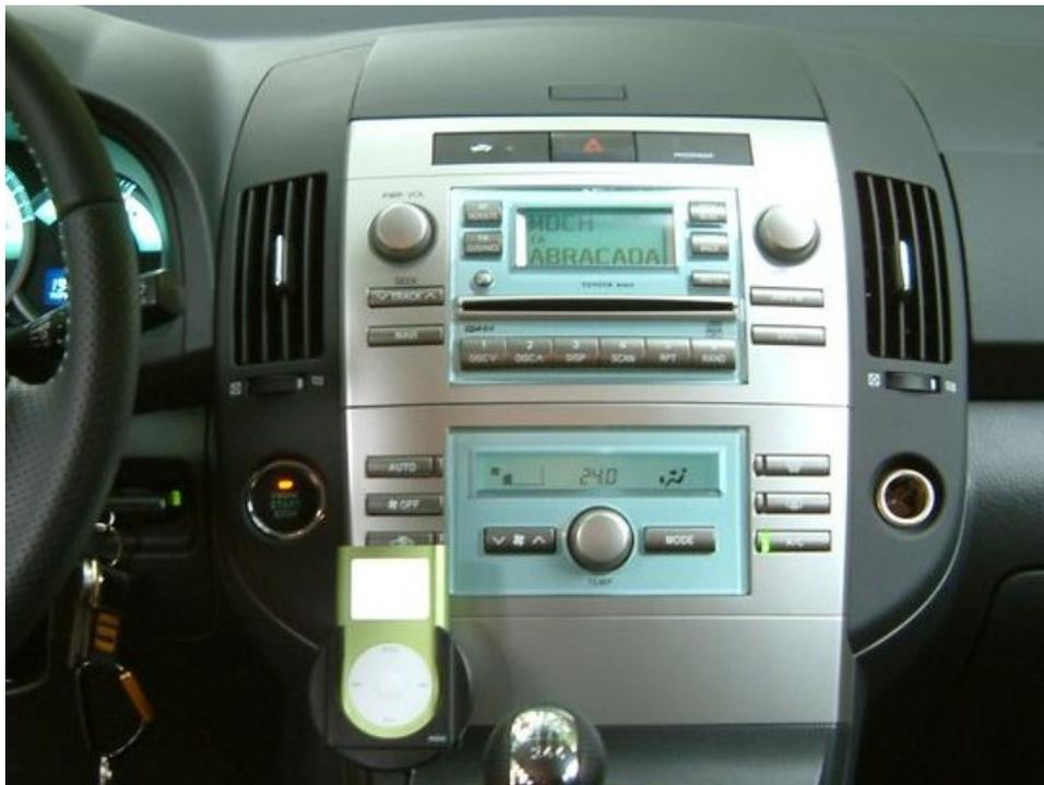
L'afficheur de l'autoradio est capable d'afficher les titres. L'adaptateur est vu comme un Chargeur de CD (MDCH).
