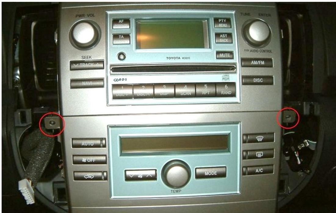
Une fois démontée, il reste à démonter l'autoradio : il est maintenu par quatre vis (les 2 premières sont entourées en rouge sur la photo, les 2 dernières sont dans les losanges orange, en retrait de 15 cm). Il faut donc prévoir un tournevis long et magnétique de préférence.
